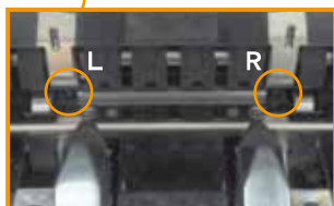
② 左右の紙幣計数センサー (受光部・発光部)
