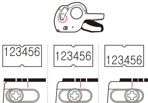
印字の位置がラベルに印刷されたデザインにかかる場合は、左右の印字固定ネジを＋ドライバーで緩めると前後に動かして印字位置の調整が可能です。
